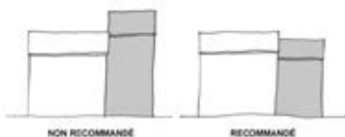
L'extension ne nuit pas à l'architecture de la maison existante et permet de garder la lisibilité des différentes phases de construction
